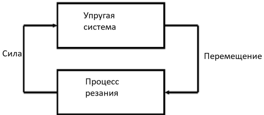
Рис. 3.1. Динамическая система станка по связи с процессом резания
